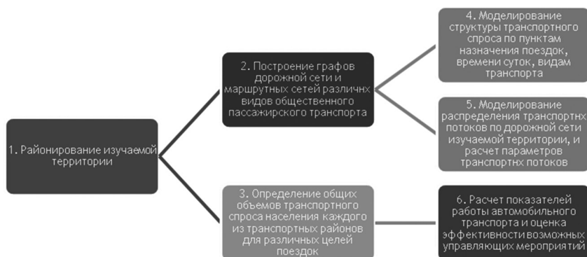
Рисунок 3. Порядок моделирования транспортной системы («моделирование мобильности»)
